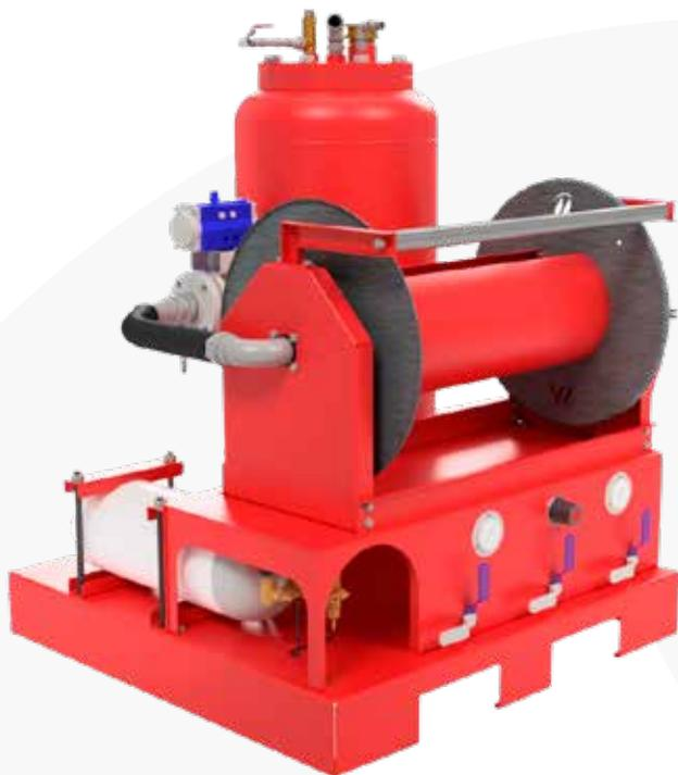
Il giunto girevole del naspo è fatto di materiale antifrizione come bronzo con tenute composite **VITON + PTFE** con passaggi interni da **1"½**, avente perdite di carico molto basse grazie allo studio della fluidodinamica interna effettuato da **MALECO**.
